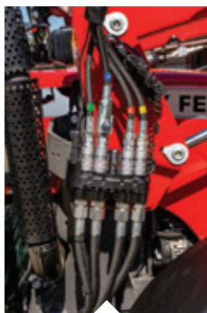
Configuración básica con acopladores únicos de cara plana
