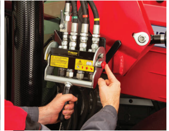
Desconecte las conexiones hidráulicas y eléctricas
