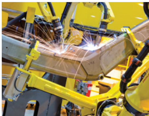
Soldadura robotizada para garantizar la precisión y la resistencia
