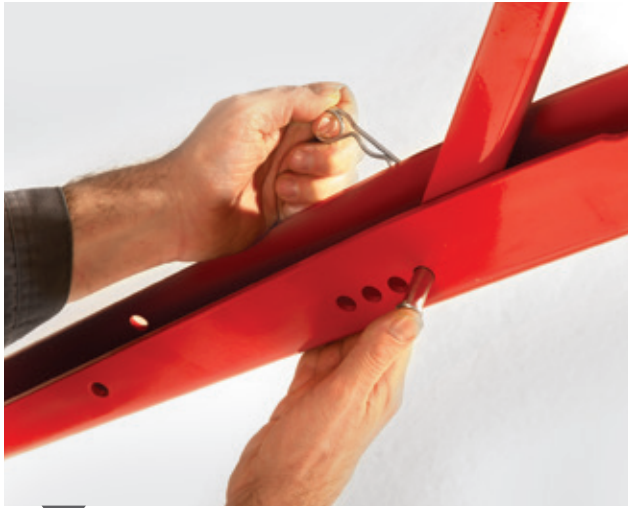
Baje los soportes de estacionamiento
